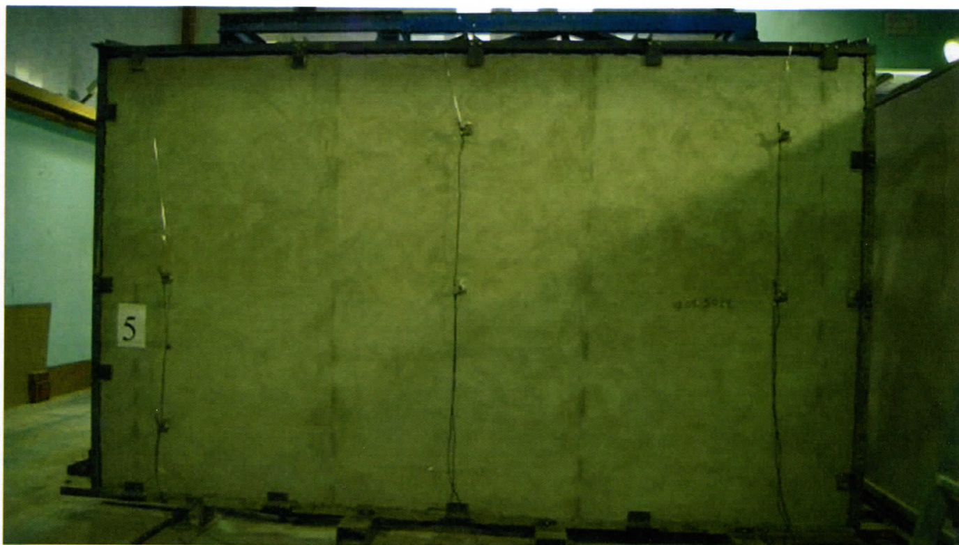
Рисунок 5.3.3 - Общий вид перегородки с датчиками перед испытанием
