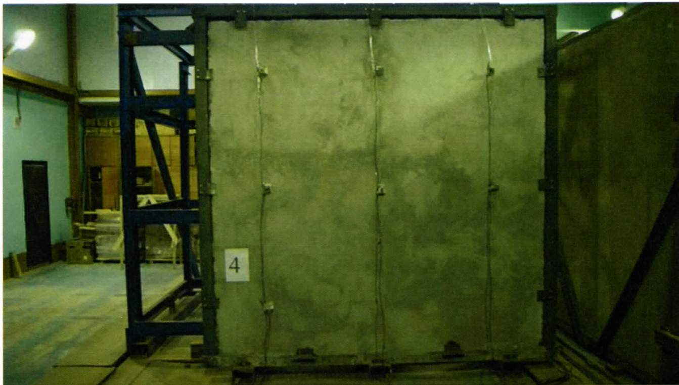
Рисунок 5.2.4 - Общий вид перегородки с датчиками перед испытанием
