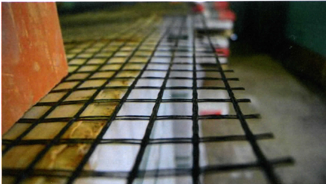
Рисунок 5.3 - Базальтовая сетка, использованная в качестве армирования
